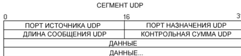
Используя данные, захваченные программой Wireshark для первой датаграммы UDP, заполните информацию о заголовке UDP. Значение контрольной суммы имеет формат шестнадцатеричного числа (основание 16) с предшествующим кодом 0x.
