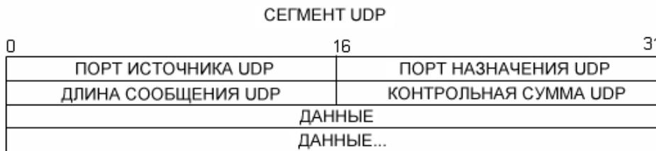
Разверните протокол UDP на панели сведений о пакетах, нажав на значок плюса (+). Обратите внимание на то, что в открывшемся окне будут только четыре поля. Номер порта источника в данном примере — 52110. Порт источника был случайно сгенерирован локальным ПК с использованием зарезервированных номеров портов. Порт назначения — 53. Порт 53 — это общеизвестный порт, зарезервированный для использования с DNS. DNS-серверы получают DNS-запросы от клиентов через порт 53.
